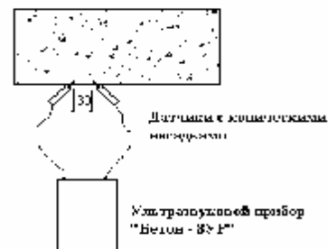
Схема УЗ измерения прочности бетона
